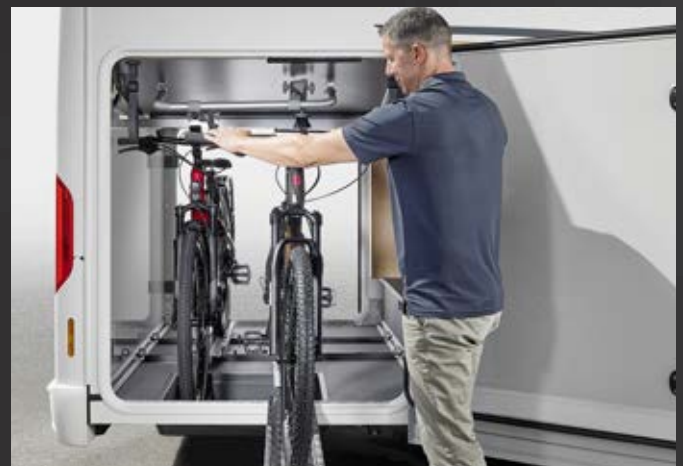
Leichte Beladung eines Pedelecs durch Einschubsystem mit einhängbarer Auffahrschiene
