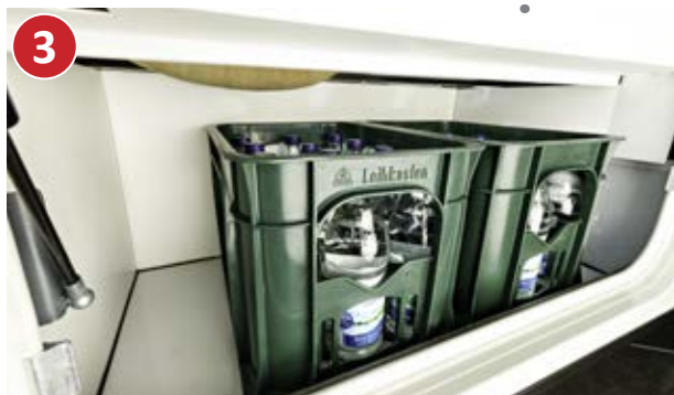
Großer, zusätzlicher Doppelboden-Stauraum mit separater Außenklappe
