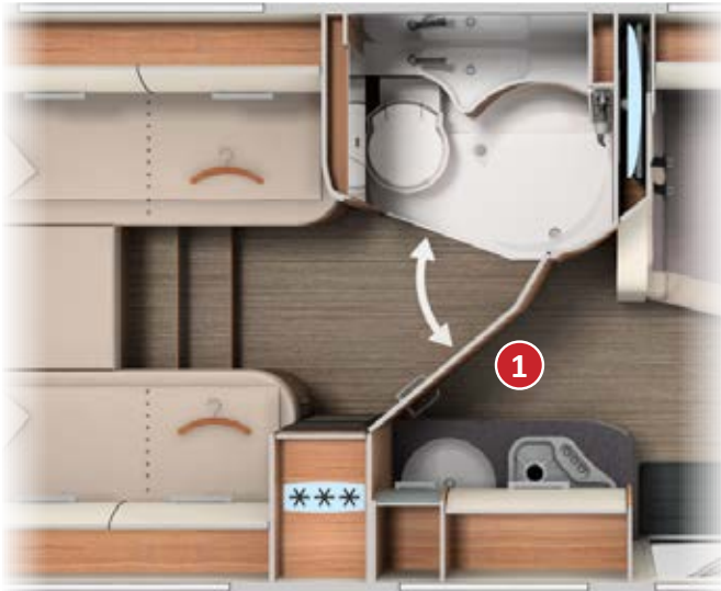
Die Waschräumtür 1 dient zur Raumteilung Wohn-/Schlafraum und schafft gleichzeitig ein blickgeschütztes Umkleidezimmer.
