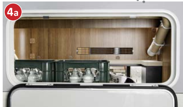
Bequemes Beladen des Doppelboden-Stauraums über große Außenklappe*
