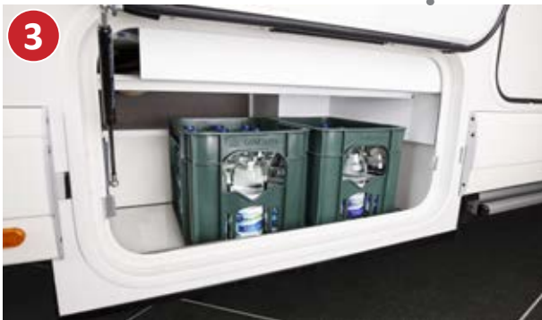
Großer, zusätzlicher Doppelboden-Stauraum mit separater Außenklappe
