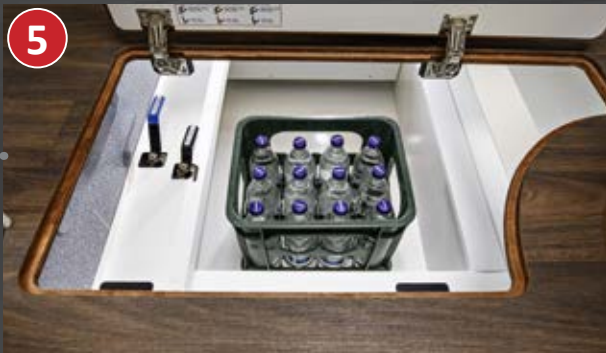
Riesige Wohnraumbodenklappe im Eingangsbereich: bei geöffneter XL-Aufbautür bequem auch von außen beladbar
