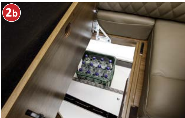
Einfache Entnahme des Staurauminhaltes von innen über aufklappbaren Sitzbankdeckel der Rundsitzgruppe mit Patentbeschlag
