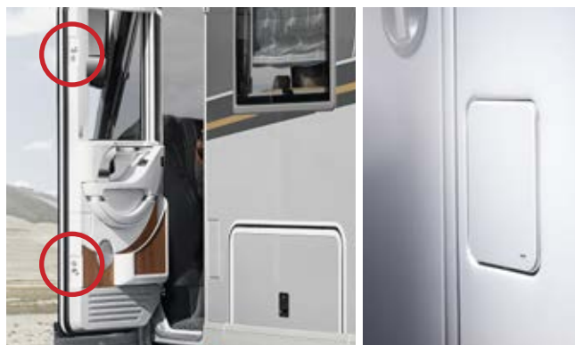
Fahrertür mit extraniedrigem Türeinstieg und Sicherheits-Doppelverriegelung, Kraftstoff-Tankdeckel flächenbündig in Seitenwand eingelassen
