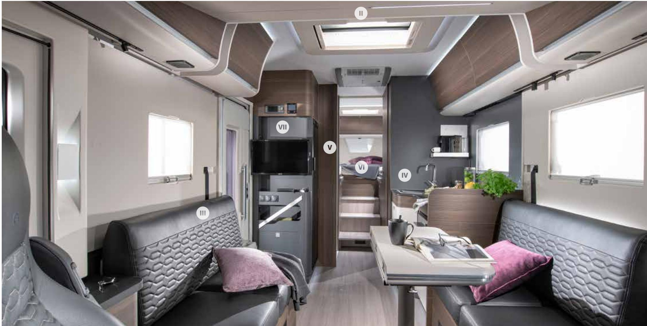
**I.** Panoramafenster mit integrierter Verdunklung, zum Öffnen für zusätzliche Belüftung.
