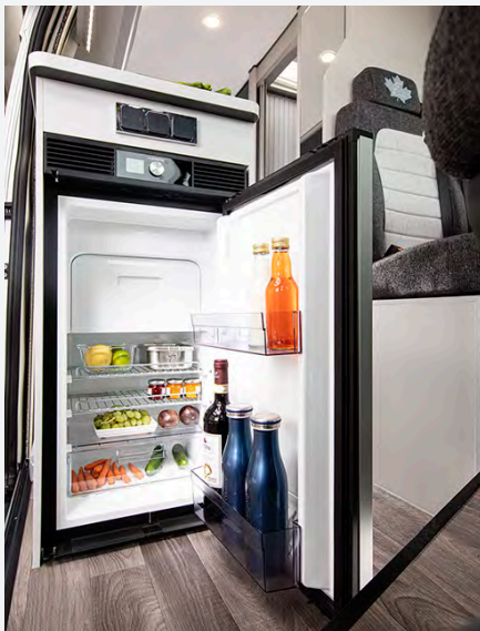
70 l Kompressor-Kühlschrank beidseitig aufklappbar von Dometic
