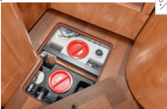
Wassertanks frostsicher im beheizten Doppelboden
