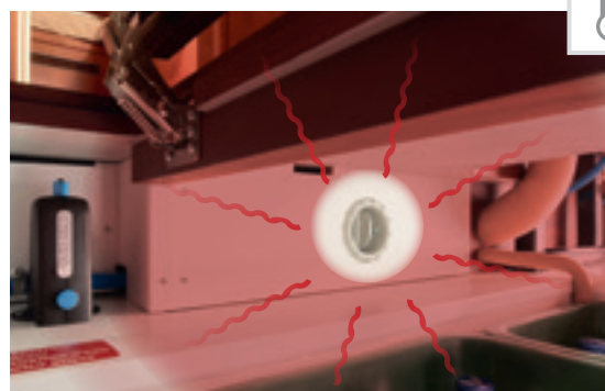
Wärmespeicher-Heiztechnik Truma Combi 6 mit Wärmeluftauslässen im gesamten Klimaspeicher-Doppelboden, im Wohnraum, in der Heckgarage, im Fahrerhaus und in den Türeinstiegen
