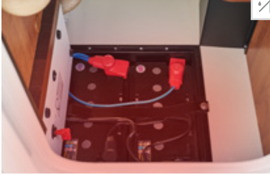
Batteriezentrale beheizt mit Batterie Hauptschalter; Serie: Gelbatterien 2 x 80 Ah, optional Lithium-Ionen-Batterie 90 Ah inklusive Batteriecomputer
