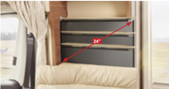
TV-Auszugssystem hinter Rückenlehne
