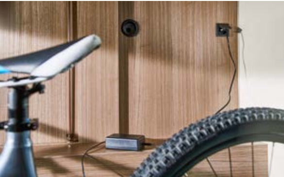
230-V-Steckdose in der Heckgarage
